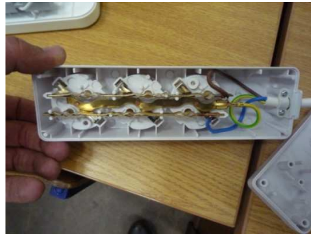
Слика 4. Отворен продужни кабл домаће производње (јасно се разазнају сва три проводника: фазни – браон, неутрални – светлоплави и заштитни – жутозелени)
