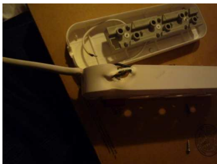
Слика 6. Оштећења настала на продужном каблу турске производње
