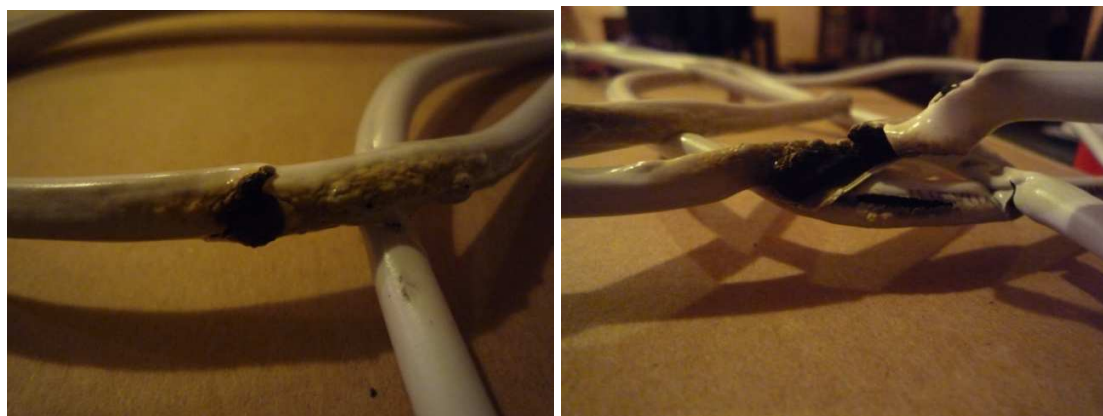
Слика 5. Оштећења настала на продужном каблу кинеске производње
